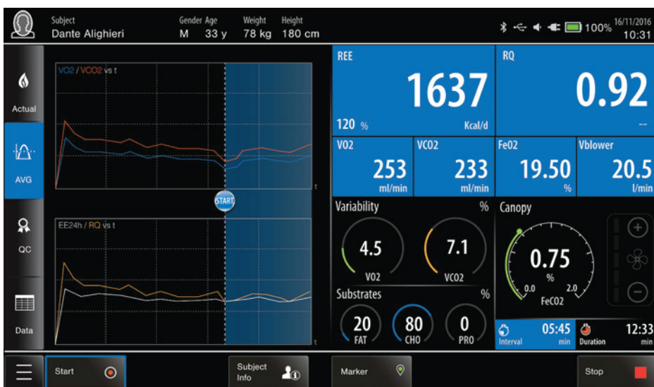
O painel em tempo real do teste com a Canopy mostra dados metabólicos e ventilatórios, além de widgets para verificar o controle de qualidade e entender sempre que o teste é concluído
