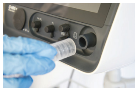
Os testes com a canopy requerem uma configuração simples, conectando a mangueira da canopy ao soprador
